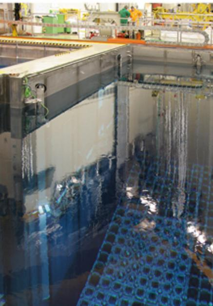
Im Abklingbecken in der Reaktorkuppel lagern noch Brennelemente unter Wasser.
