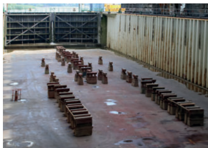
Die aufgestellten Pallen für das Schiff Kugelbake im Trockendock.
