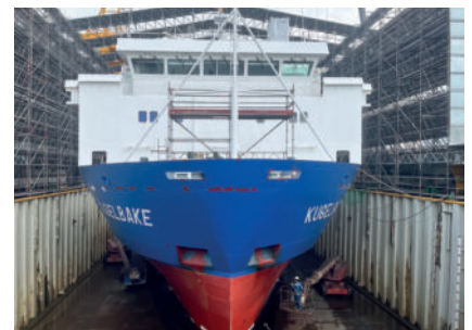
Nach Ablassen des Wassers steht die Kugelbake sicher im Trockendock und die Arbeiten können beginnen.
